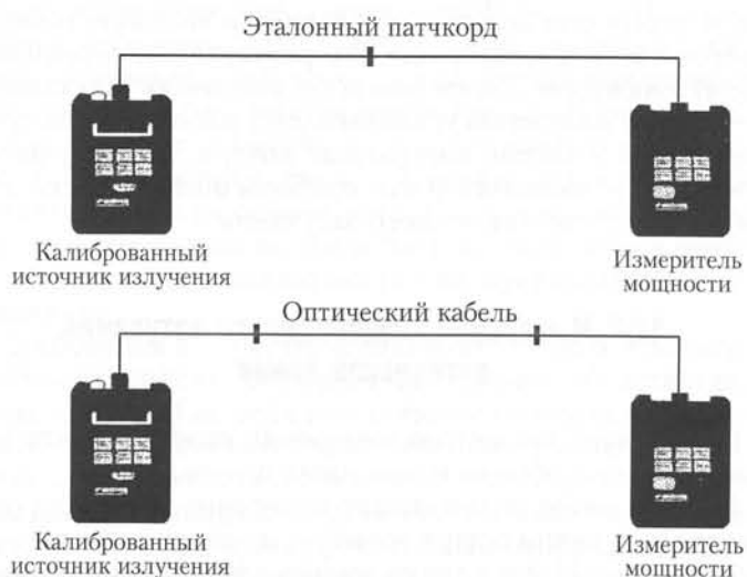
Рис. 12.2. Схема определения затухания волокна методом вносимых потерь
