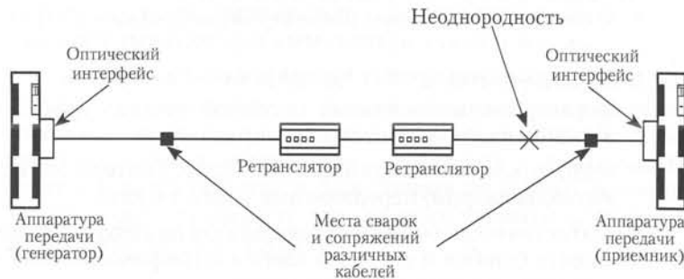
Рис. 12.1. Типовая схема волоконно-оптической линии связи
