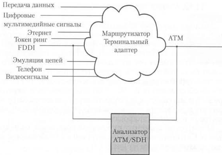
Рис. 11.17. Схема организации тестирования шлюза между магистральной и локальной сетями
