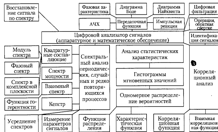
Рис. 5.20. Функциональные возможности цифрового анализатора спектра
