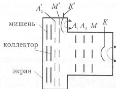
Рис. 4.2. Упрощенная схема запоминающей ЭЛТ: A_2', M', K' — воспроизводящая система
