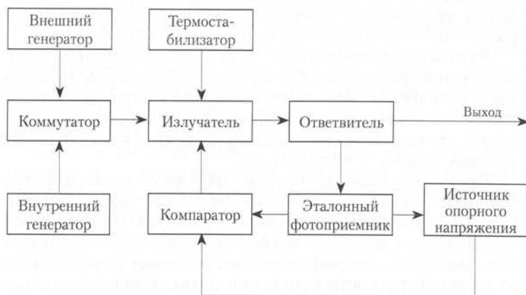
Рис. 12.14. Схема устройства стабилизированного источника оптического сигнала
